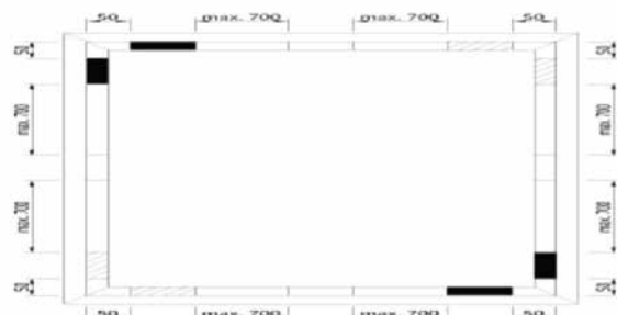
Obr. 3 Zásady pre vypodloženie skla (PVC)
